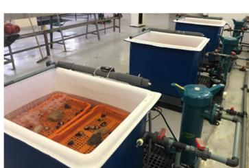
Se diseñó y construyó un sistema de depuración con recirculación de agua a escala de laboratorio.
