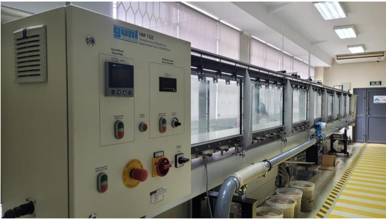
Fig. 1. Canal Hidraulico Marca: G.U.N.T. Hamburg Modelo No.: HM 162 Longitud: 10 m Area: 0.309 m ancho x 0.450 m alto Pendiente: 0.0° ± 0.2° Flujo de agua: 90 m3/h
