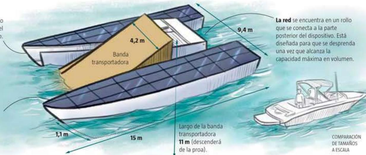
La red se encuentra en un rollo que se conecta a la parte posterior del dispositivo. Está diseñada para que se desprenda una vez que alcanza la capacidad máxima en volumen.
