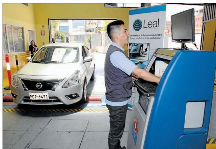
Andrés Urbina, del Cicev de la EPN, opera desde el laboratorio una máquina que mide la potencia de un auto, que simula movimiento real.
