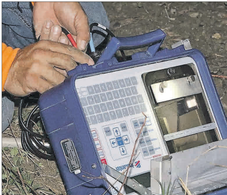
Prueba. Un técnico calibra la máquina para medir la vibración del suelo.
