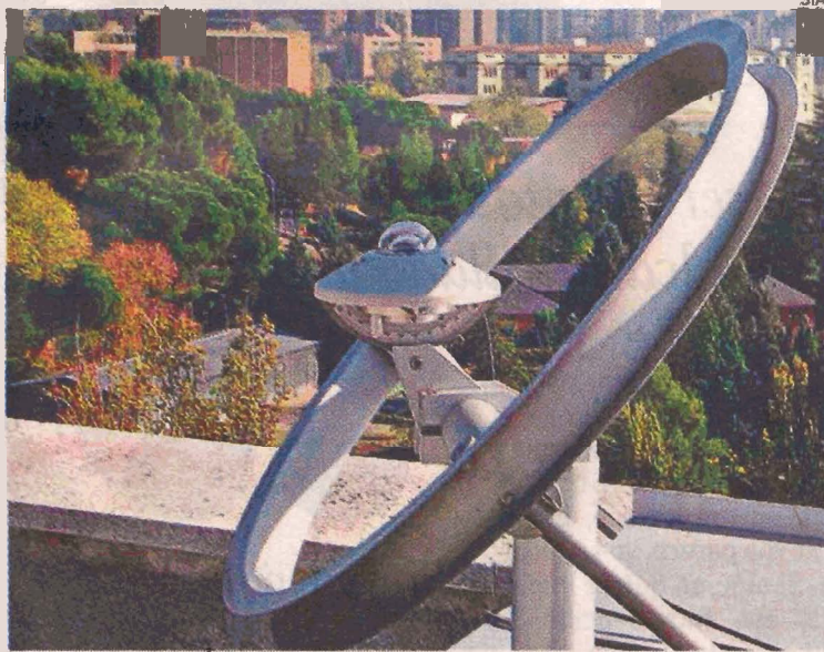
EL PIRANÓMETRO. Es un equipo que mide la radiación solar.
